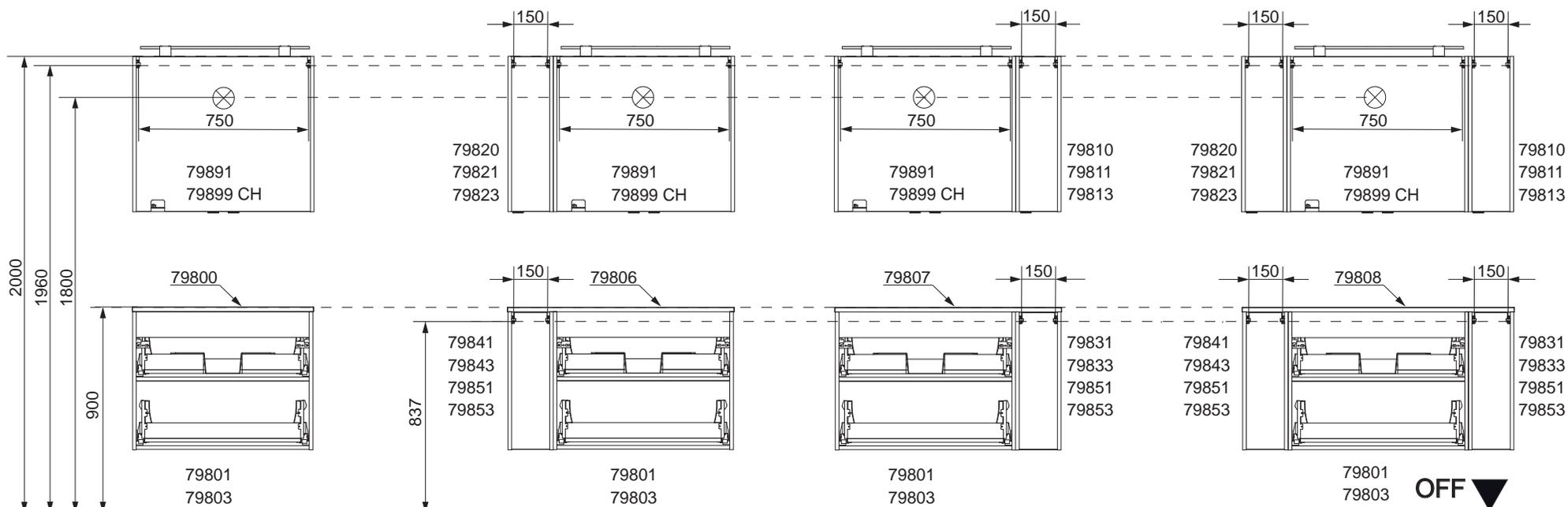
OFF = Oberkante fertiger Fußboden
